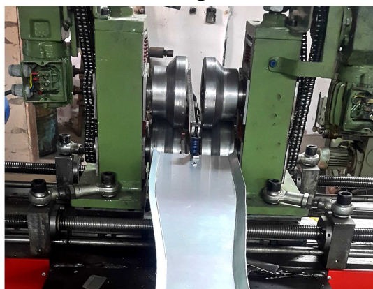
ب) نمایی از دستگاه شکل دهی غلتکی انعطاف پذیر ساخته شده در دانشگاه تربیت دبیر شهید رجایی.
