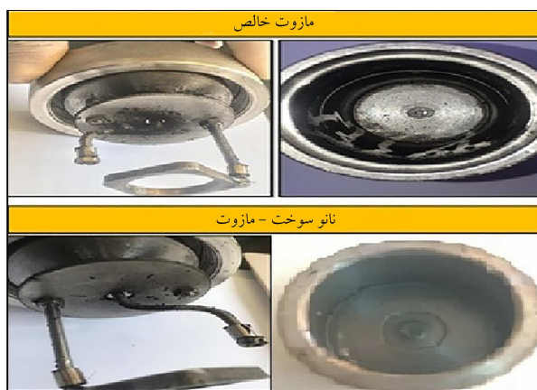
شکل ۱۰. تفاوت میزان دوده در دو حالت مازوت خالص و نانو سوخت - مازوت در محفظه احتراق.
