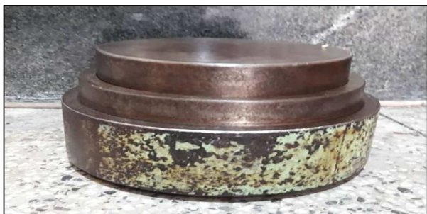
شکل ۲. مونتاژ ماتریس پشتیبان چند نقطه‌یی در حالت مونتاژی سه پله.
