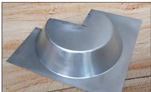
شکل ۳. نمونه برش خورده در راستای نورد جهت اندازه‌گیری توزیع ضخامت.
