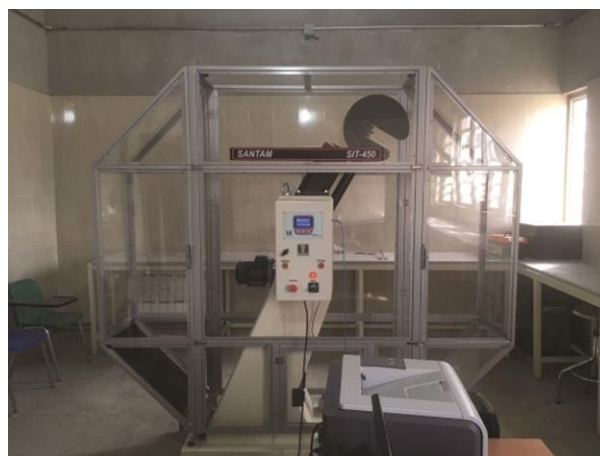
شکل ۲- نمای کلی از دستگاه ضربه شاری مجهز شده سننام مدل SIT-۴۵۰
