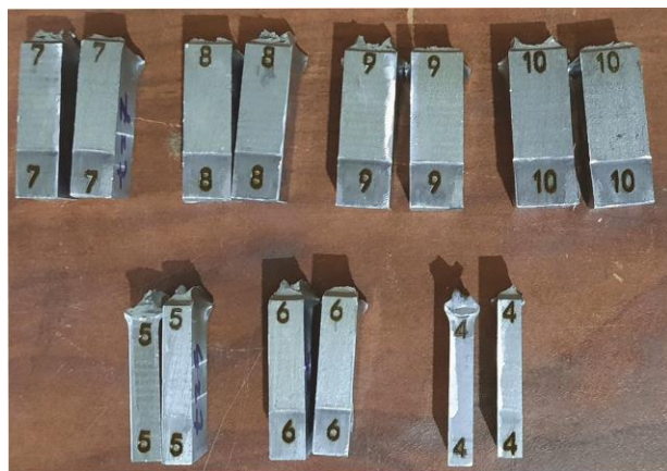
شکل ۳- یک دسته از نمونه‌های شاری بعد از شکسته شدن در نیتروژن مایع (اعداد ضخامت‌های نمونه شاری هستند)
