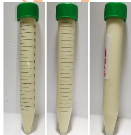
شکل ۲- پایداری نانوسیال TiO_2 در بازه‌های زمانی متفاوت روز اول روز هفتم روز سی ام
