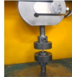
شکل ۱- آزمایش کشش منیزیم خالص (الف) نمونه استفاده شده برای آزمایش کشش (ب) دستگاه آزمایش کشش [۲۶]
