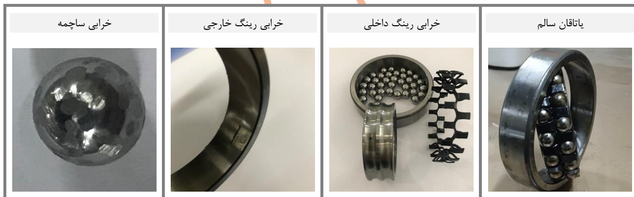
شکل ۵: نمایش خرابی‌های ایجاد شده در یاتاقان غلتشی
