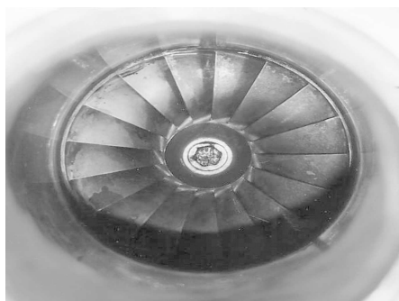
شکل ۲. چرخ توربین فرانسسیس افقی.
