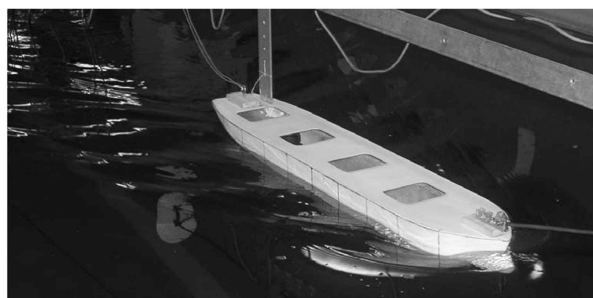
شکل ۵. کشش مدل در حوضچه با سرعت 0.61 \text{ m/s} .
