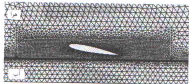
شکل ۷. شبکه‌بندی اطراف فویل نزدیک سطح آب.
