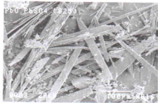
شکل ۶. تصویر میکروسکوپ الکترونی ترکیب PbSO_4 \cdot PbO تهیه شده به روش شیمی‌تری با بزرگ‌نمایی ۲۰۰۰ برابر.
