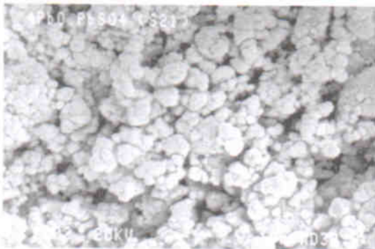
شکل ۱۰. تصویر میکروسکوپ الکترونی ترکیب PbSO_4 \cdot 4PbO تهیه شده به روش گرمایی با بزرگ‌نمایی ۴۵۰۰ برابر.
