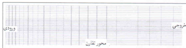
شکل ۲. هندسه‌ی شبکه‌بندی شده اتاق احتراق.
