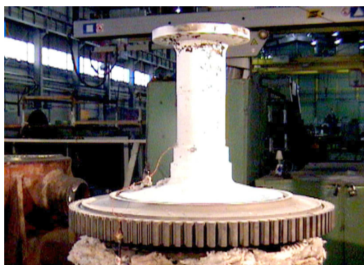
شکل ۹. پوشش‌دهی سطح شفت با آهک.
