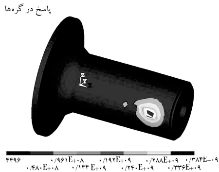
شکل ۶. توزیع تنش فشاری (MPa) از حل تحلیل سازه‌ی با نرخ حرارتی ۶۷ °C/hr.
