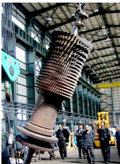
شکل ۸. آویزان کردن روتور از سقف.
