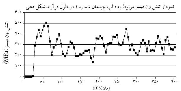
شکل ۱۲. مقادیر تنش ون میسز قالب از جنس فولاد ریخته‌گری، مربوط به چیدمان شماره ۱.
