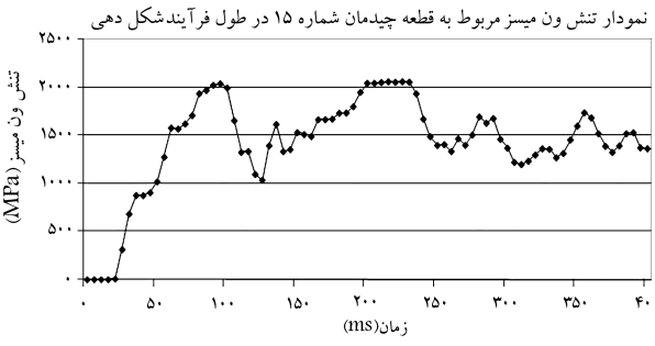
شکل ۱۰. نمودار بیشینه تنش ون میسر، چیدمان شماره ۱۵.
