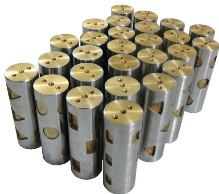
شکل ۳. مجموعه استاتورهای ساخته شده.
