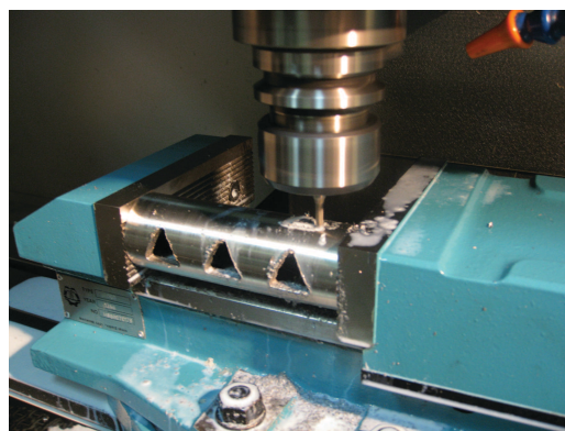
شکل ۲. فرایند ماشین‌کاری حوضچه‌های هوایی با فرز CNC.
