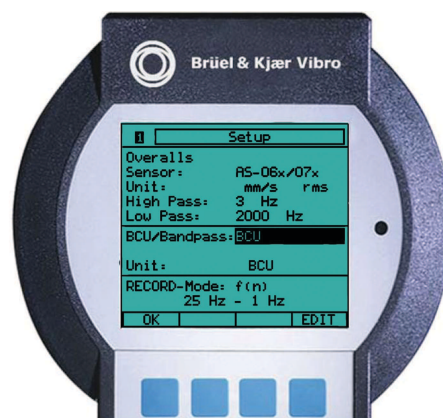
شکل ۵. تنظیمات محیط اندازه‌گیری مقدار ارتعاش در دستگاه ارتعاش‌سنج VibroTest ۶۰.
