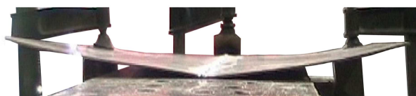
الف) تغییر شکل پوسته‌های جوش شده بعد از اتمام جوشکاری و قبل از باز شدن قیود مکانیکی؛
