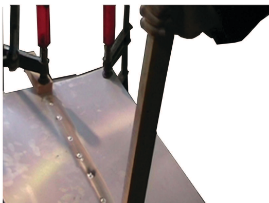
ب) خال جوش های زده شده برای جلوگیری از جدا شدن لبه های قطعات به هنگام جوشکاری؛
