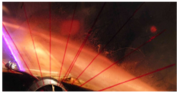
شکل ۵. تصویری از محل نصب عملگر بر روی ایرفویل و تشکیل پلازما بر روی آن.
