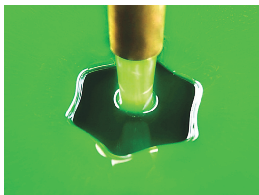
شکل ۲. نمونه‌یی از پرش هیدرولیکی غیردایره‌یی پایدار به شکل شش ضلعی. سیال عامل اتیلن‌گلیکول است (عکس از تحقیق حاضر).
