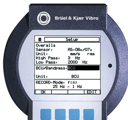
شکل ۶. تنظیمات محیط اندازه‌گیری مقدار ارتعاش در دستگاه ارتعاش‌سنج ۶۰ VibroTest.
