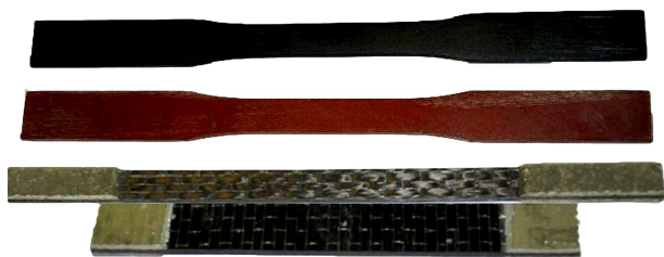
شکل ۵. نمونه‌های نانوکامپوزیت آماده شده برای آزمایش کشش.
