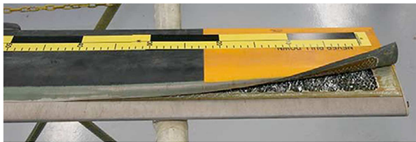
شکل ۳. حالت واماندگی لایه لایه شدن ملخ بالگرد.
