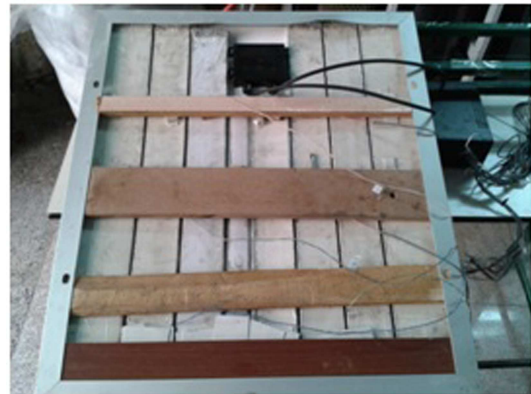
شکل ۱. تصویر پشت پنل دارای محفظه، حاوی ماده تغییر فاز.
