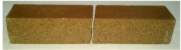
شکل ۲۰. سطح شکست در نمونه ی بتن پلیمری که تحت بار خمشی قرار گرفته است.
