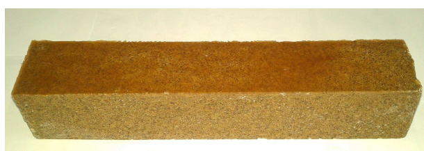
شکل ۵. نمونه‌ی خمش سه نقطه‌ی بتن پلیمری.
