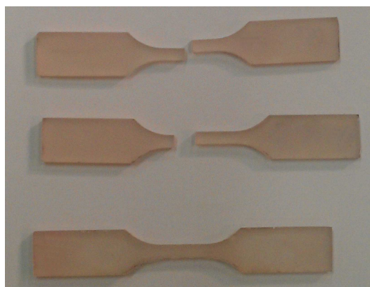
شکل ۷. تصویر چند نمونه‌ی کششی کوچک رزین پلی استر بعد از انجام آزمایش و یک نمونه‌ی سالم.
