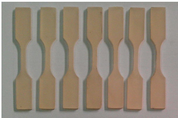
شکل ۱. نمونه‌های کششی کوچک رزین پلی استر مطابق با استاندارد Type V ASTM D۶۳۸.
