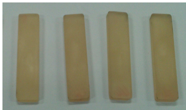
شکل ۳. نمونه‌های خمش سه نقطه‌ی رزین پلی‌استر.
