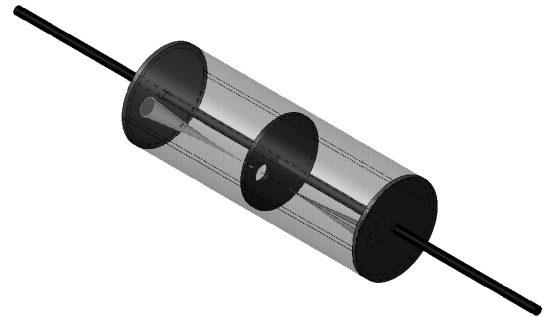
شکل ۴. نمای سه‌بعدی میراگر غیرخطی وابسته به مکان و سرعت.
