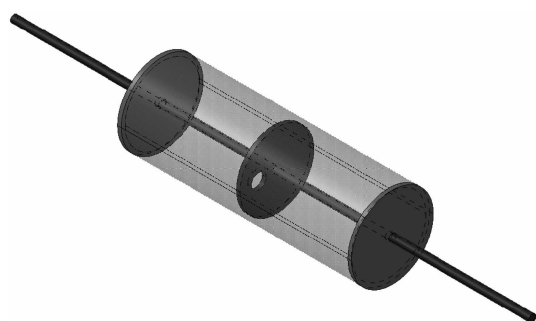
شکل ۲. نمای سه بعدی یک میراگر ویسکوز ساده.
