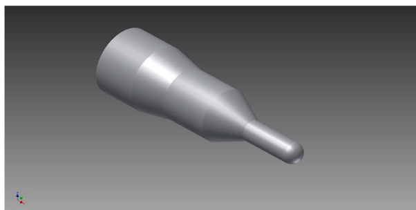
شکل ۳. طرح سه بعدی هورن آلومینیومی استفاده شده در این آزمایش (طراحی با نرم افزار Inventor).
