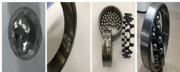
شکل ۵. نمایش خرابی‌های ایجاد شده در یاتاقان غلتشی.
