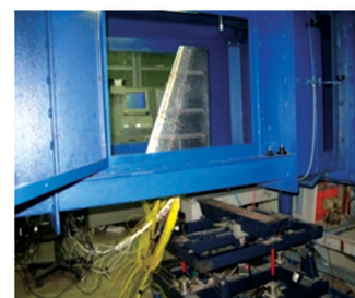
شکل ۴. نحوه‌ی قرارگیری بال در تونل باد، سیستم مختصات و موقعیت قرارگیری سوراخ‌های فشار روی بال.
