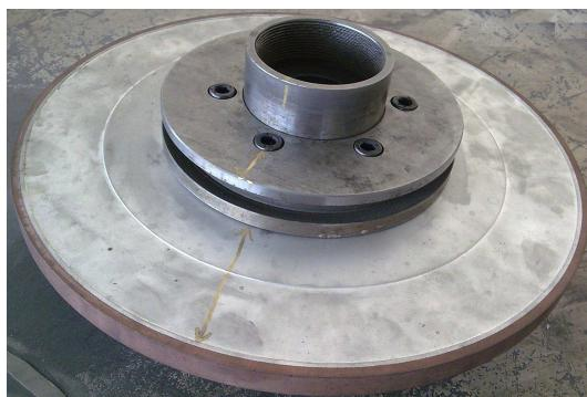
شکل ۲. نمایی از سنگ الماس ۱A1 و توبی ساخته شده برای آن.
