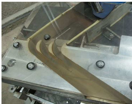
شکل ۱۰. طرح‌واره‌ی بخش ردیف پره‌ی استاتور در یک زاویه‌ی برخورد معین. [28]
