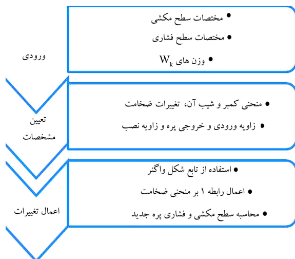
شکل ۳. رویه‌ی انجام تغییرات هندسی بر پروفیل روتور یا استاتور.
