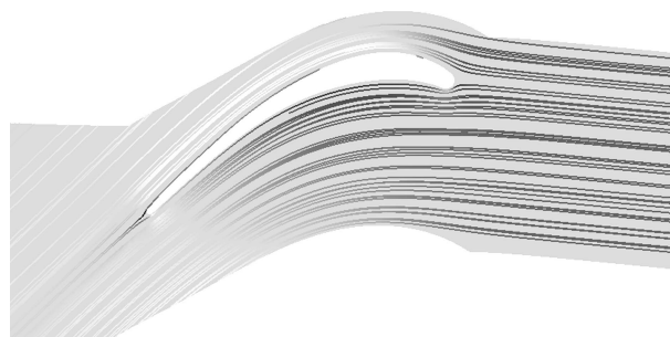
شکل ۱۵. خطوط جریان اطراف ردیف پره‌ی روتور در زاویه‌ی برخورد ۱۵ درجه.
