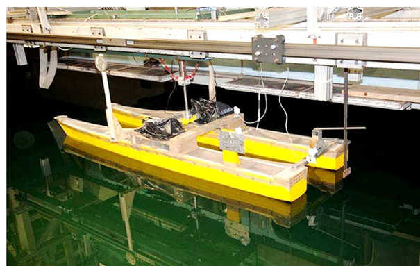
شکل ۷. نمایی از آزمون شناور کاتاماران توسط بوستکس. [۳۲]
