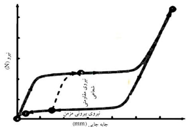
نمودار ۲. شمایک نیروهای موجود در هنگام بارگذاری و باربرداری استنت هوشمند. [۲۹، ۱۲]
