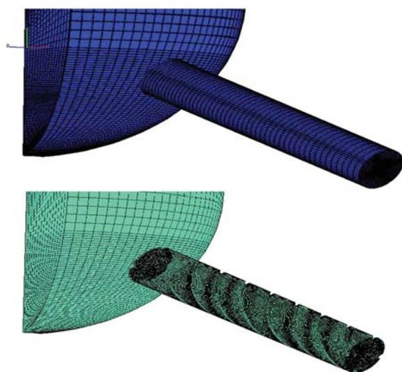
شکل ۴. جزئیات شبکه‌بندی انژکتور در نزدیکی سوراخ نازل در حالت‌های مختلف بدون شیار (بالا) و با شیار (پایین).
