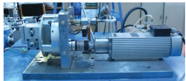
شکل ۳. بستر آزمایش سخت افزار در حلقه واحد کنترل سوخت.
