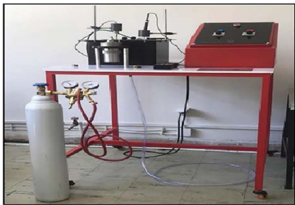
شکل ۴. بمب کالری سنج تهیه شده در پژوهشگاه مواد و انرژی.
