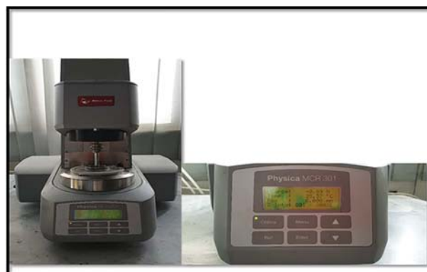
شکل ۷. دستگاه رتومتر استفاده شده برای مطالعه کمی خواص رئولوژیکی نانوسیال.
