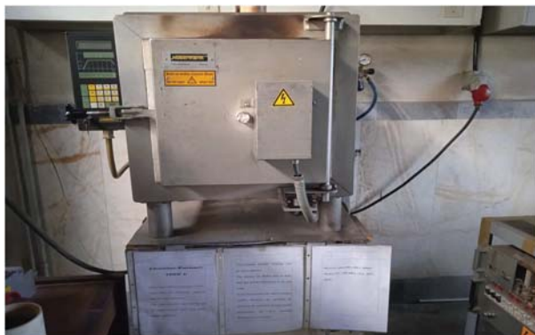
شکل ۴. کوره الکتریکی استفاده شده در این آزمایش (Nabertherm D - 2804).
