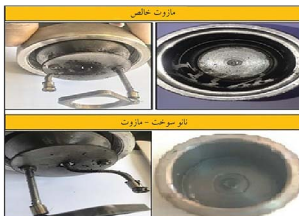
شکل ۱۰. تفاوت میزان دوده در دو حالت مازوت خالص و نانوسوخت - مازوت در محفظه احتراق.
