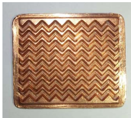
شکل ۹. تصویر میکروکانال مسی پژوهش حاضر.
