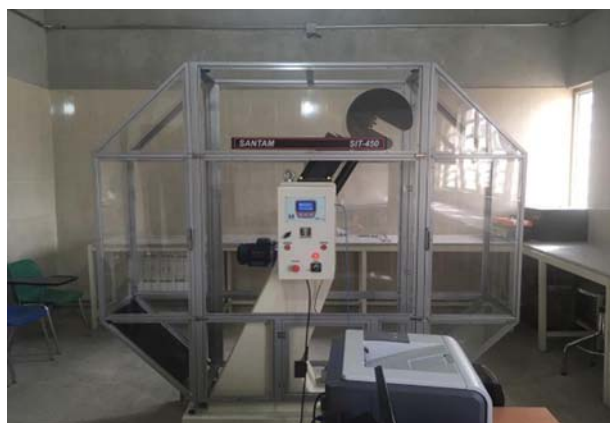
شکل ۲. نمای کلی از دستگاه ضربه شاریپی مجهز شده سنتام مدل SIT-400.
