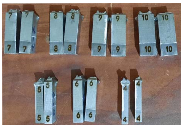
شکل ۳. یک دسته از نمونه‌های شاریپی بعد از شکسته شدن در نیترژن مایع (اعداد ضخامت‌های نمونه شاریپی هستند).
